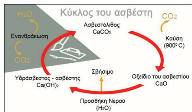
Εικόνα 2: Εικονογραφική απόδοση της παρασκευής πολτού ασβέστη.
