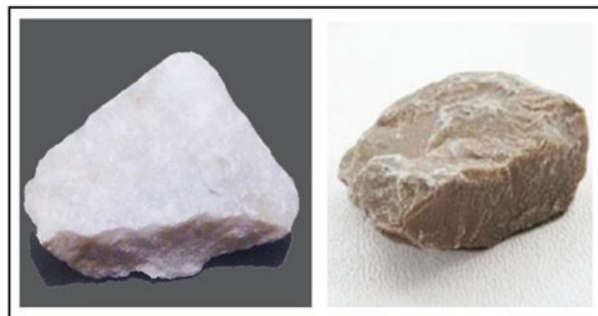
Εικόνα 1: α) Ασβεστόλιθος καθαρός β) Ασβεστόλιθος με προσμίξεις
